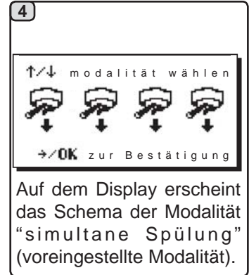
Die Taste Kaffeekreisspülung (26) einige Sekunden gedrückt halten.
