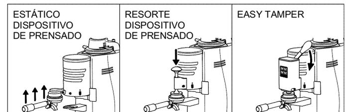
**DISPOSITIVO DE Prensado ESTÁTICO:** colocar el porta filtro contra el lado inferior del dispositivo de prensado y empujar hacia arriba.
