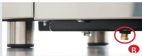
9. Si necesita ajustar la presión de la bomba, lo puede hacer desde la parte externa e inferior de la máquina (Fig B). Con cuidado, usando una llave de tubo, afloje el anillo de bloqueo para ajustar la presión de la bomba.
