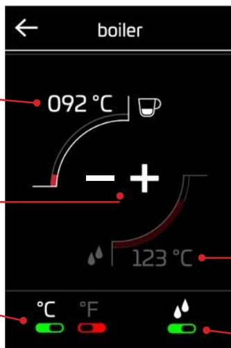
Pulse aquí para cambiar la temperatura del calentador de servicio
